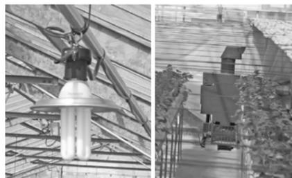
▲紫外線UV・炭酸ガス発生装置
